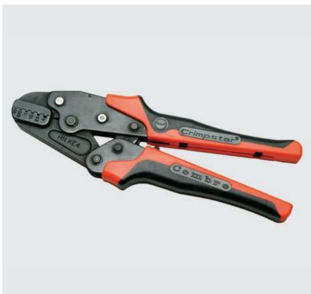
A HNKE4 é uma ferramenta de cravação manual da série Crimpstar, projetada para trabalhar com terminais tubulares (end sleeves) de 0,5 a 4 mm<sup>2</sup>, oferecendo eficiência, praticidade e qualidade para aplicações elétricas.
