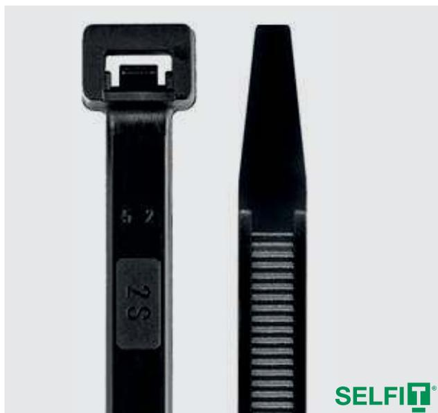
Abraçadeiras Standard Selfit são fabricadas em poliamida 6.6 autoextinguível (UL94:V2). Consistem num corpo com uma cremalheira interna de bordas arredondadas e suaves, e uma cabeça quadrada com dente de aperto em poliamida.
