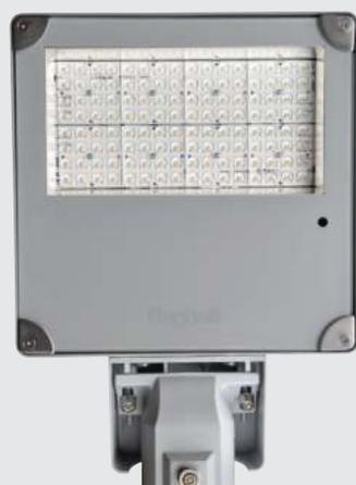
Esta gama de luminárias foi testada para responder aos standards IP65 e IK08, com temperaturas de funcionamento de -20° a +40°. O corpo da luminária foi concebido em alumínio fundido sob pressão e em aço para maior durabilidade. O grande dissipador de calor é o resultado de simulações de dinâmica de fluidos para garantir uma elevada vida útil da luminária.
