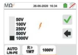
Seleção da tensão de teste e valor limite mínimo na medição em MΩ
