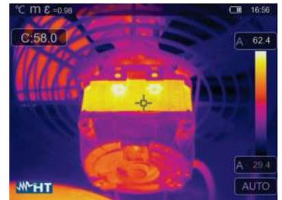
O superaquecimento de componentes em sistemas mecânicos pode ter várias causas, como bombas sobrecarregadas, lubrificação insuficiente, rolamentos aquecidos ou desalinhamentos. Como resultado, a temperatura de equipamentos ou sistemas defeituosos pode aumentar rapidamente, levando a danos irreversíveis.
