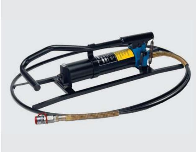
Bomba oleodinâmica de acionamento por pedal com avanço a 2 velocidades, caracterizada por um novo circuito oleodinâmico, alavanca do pedal projetada ergonomicamente e peso reduzido. Está equipada com um tubo flexível de alta pressão com 3 metros de comprimento, completo com acoplamento rápido fêmea com bloqueio automático. A pressão pode ser liberada a qualquer momento através do pedal apropriado. Uma base robusta torna o conjunto prático e estável.
